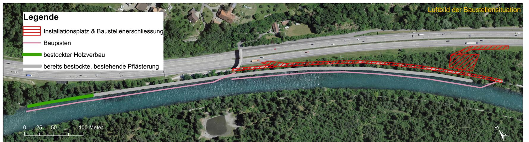
Durch den neuen Uferverbau entstehen Kleinstrukturen im Bereich der Sommerwasserlinie. Zusätzlich werden ungefähr 70 Wurzelstöcke, welche mit einem Natursteinblock beschwert werden (sog. Wurzelsteine), ins Wasser eingebaut. Diese Aufwertung der Aare als Lebensraum kommt unter anderem verschiedenen Fischarten zugute.
