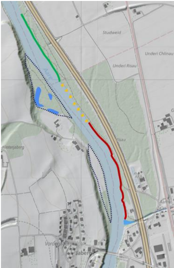
Abbildung 13: Projektübersicht. Rot: Strukturierter Blocksatz; orange: Bühnen L = 7.5 m und a = 30 m; grün: Interventionslinienkonzept; hellblau: Aufwertung der Chisemündung; schwarz gestrichelt: passive Aufwertung Schulhausstrasse und Tümpel Hinter Jaberg mit passiver Aufwertung.
