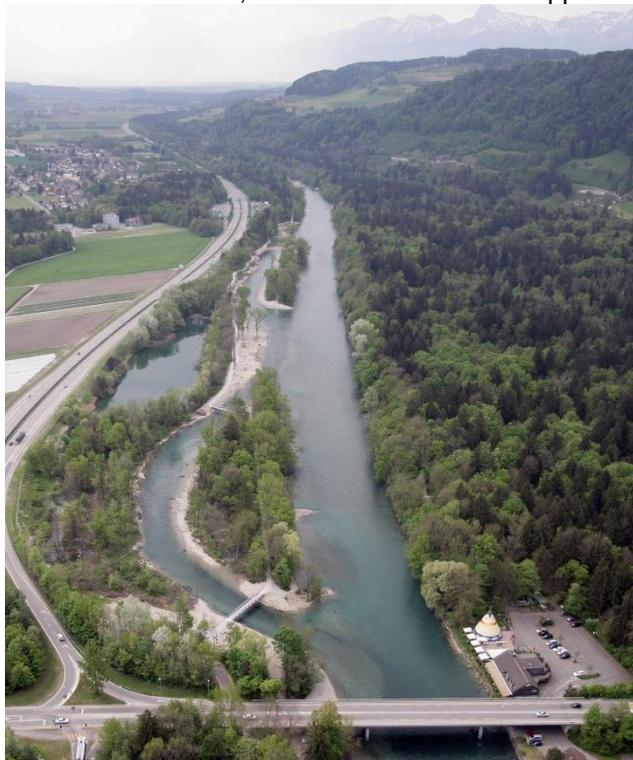
Flussverbreiterungen und neue Seitenarme wie in der Hunzigenau verringern die Fließgeschwindigkeit und bremsen die Sohlenerosion.
