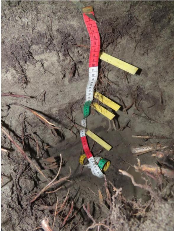
Bodenprofil HW 2 mit rascher Schichtabfolge (Organische Lagen und Sandschichten)
