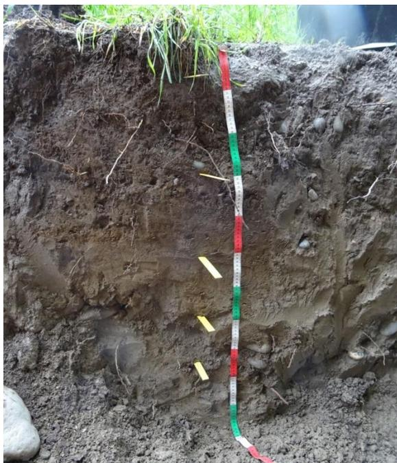
Bodenprofil HW 1 mit Spuren von früheren Umlagerungen (anthropogen)
