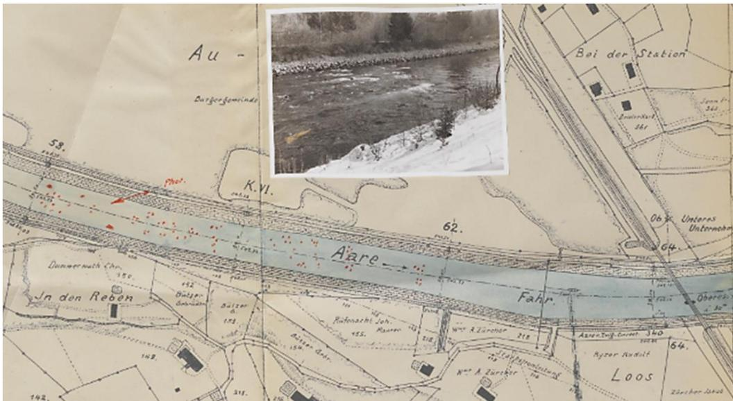
Abbildung 2.5 Planausschnitt mit dem Verbau von Einzelblöcken in der Aare aus dem Jahr 1937/38
