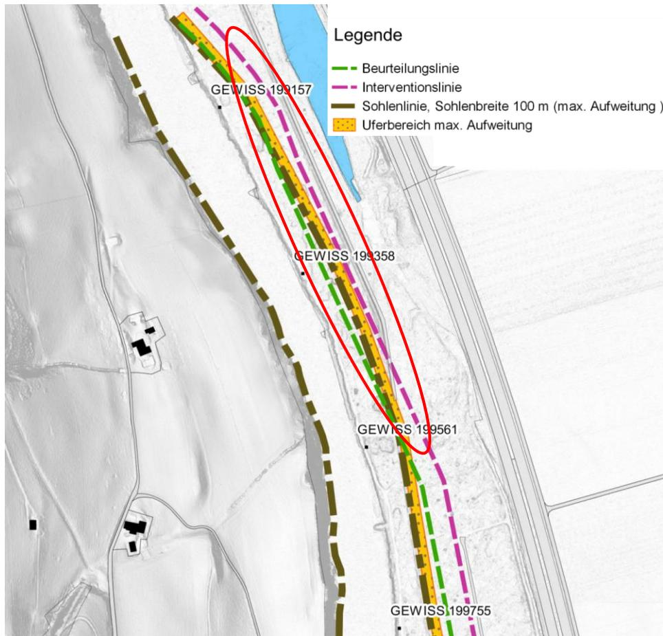
**Abb. 8** Bereich mit berücksichtigten Leitwerken im Kurvenaussenbereich.
