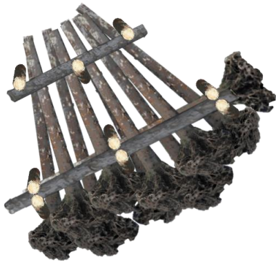
Abbildung 29: Aufbauschema eines Deflektor-ELJs und Beispielbild von zwei ELJ-Deflektoren aus der Sense.
